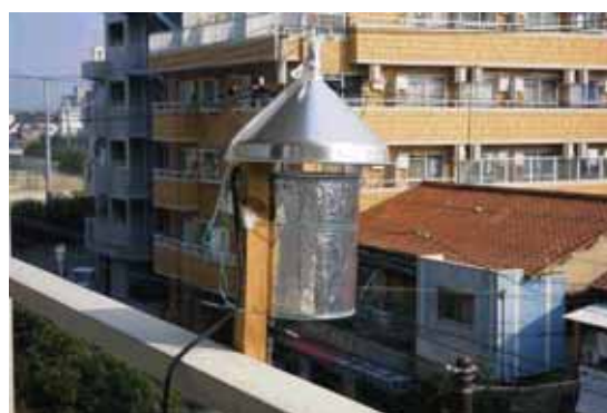
図6 計測用の簡易百葉箱
