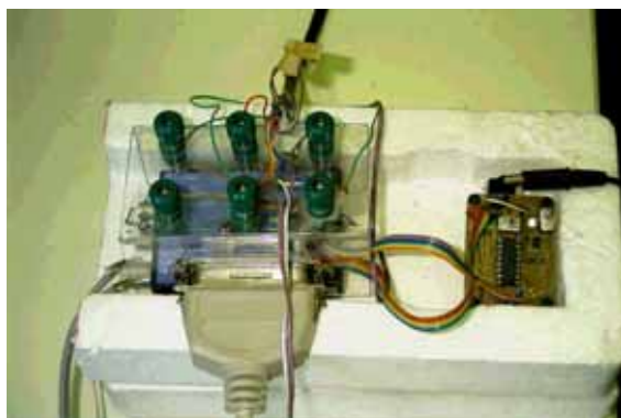
図3 プリンター端子を用いたA/D変換
