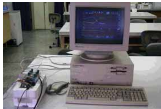
図2 パソコン及びA/D変換部
